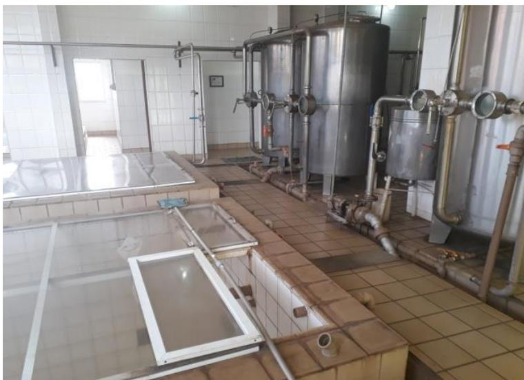
**Figura 03.** Tanque de armazenamento de Padronização de aguardente.
