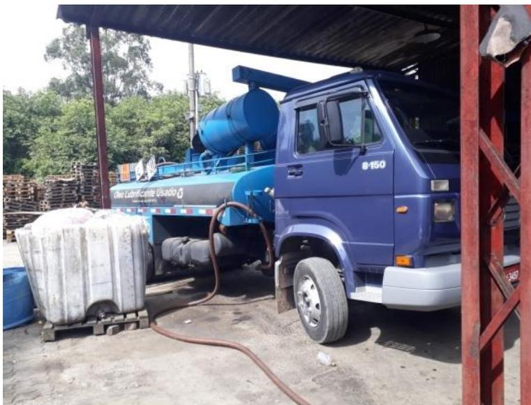
**Figura 12.** Caminhão sendo preparado para o recebimento de óleo usado da caldeira.
