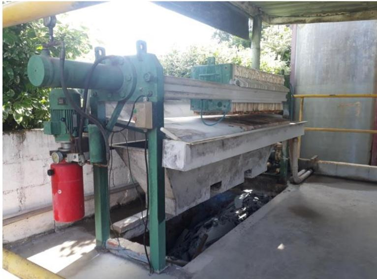
**Figura 29.** Filtro prensa de lodo - lado
