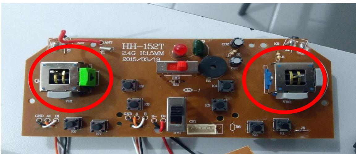
Figura 7 – Controle do drone escolhido desmontado. Os círculos vermelhos indicam os potenciômetros.
