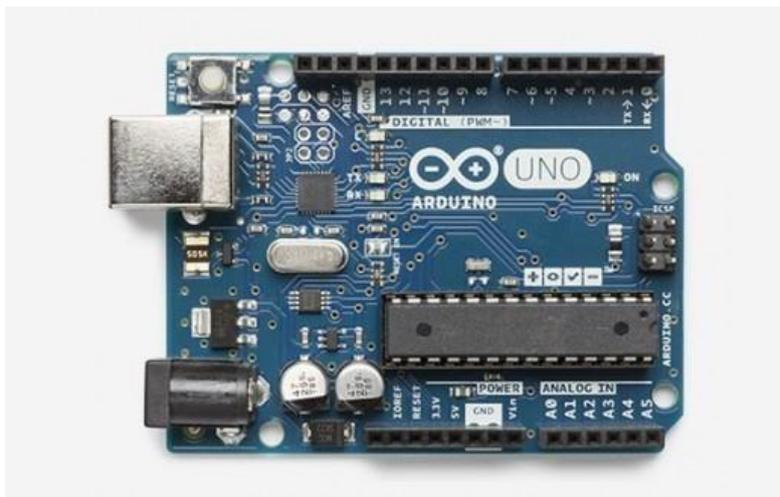
Figura 5: Placa Arduino UNO
